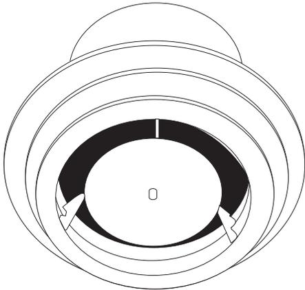
Le diffuseur d'air variable VAL se compose d'un anneau de contrôle de l'air intérieur permettant un réglage manuel ou motorisé afin de s'adapter aux diverses situations.
