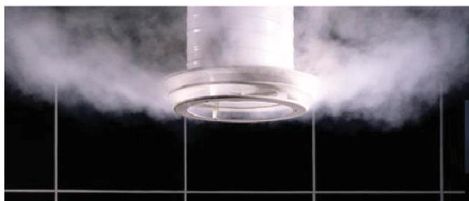
Écoulement horizontal - Mode refroidissement
